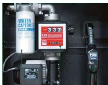
Filtre décanteur d'eau    Volucompteur 3 chiffres + totaliseur    Pistolet automatique + 8m de flexible
